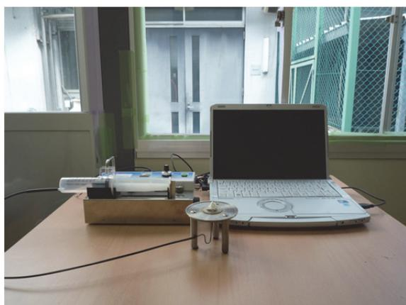
写真1 間欠的炭酸ガス正弦波発生装置
