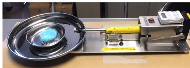
図1 固形アルコール燃料の炭酸ガス発生装置
