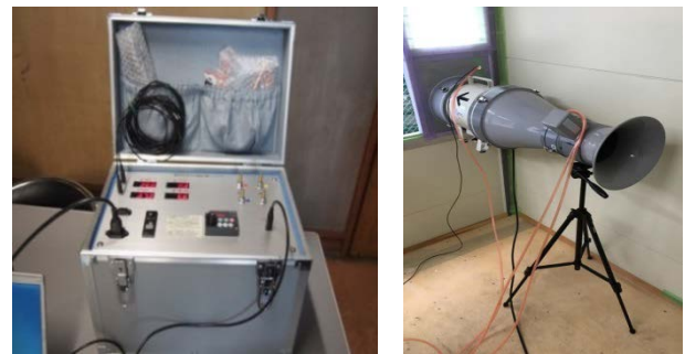
写真1 建物気密性自動多点計測システム
