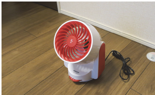
図-4 攪拌用のサーキュレータ
