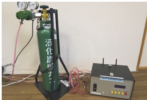
図-3 炭酸ガスボンベと炭酸ガス流量制御装置
