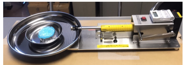
図-1 固形アルコール燃料の炭酸ガス発生装置
