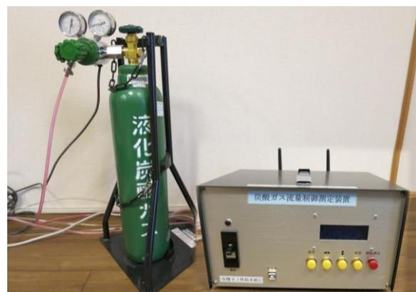
図-2 炭酸ガスボンベと炭酸ガス流量制御装置
