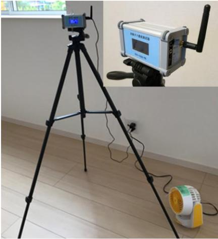
図3 炭酸ガス濃度と温湿度の測定器とサーキュレーター
